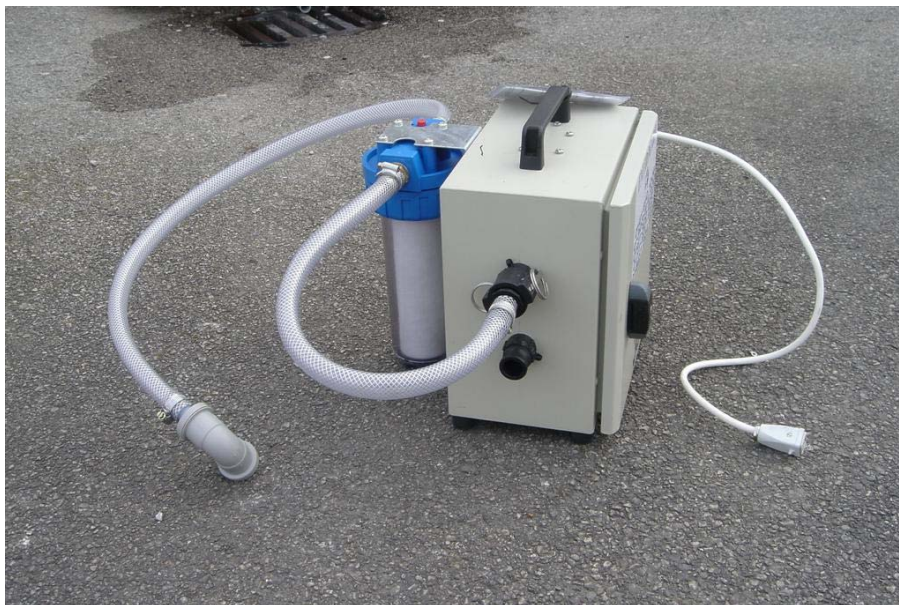
Fotografía 8.1 Equipo de filtración de agua para las aguas residuales procedentes de la unidad de descontaminación. Fotografía cedida por el HSE del Reino Unido.
