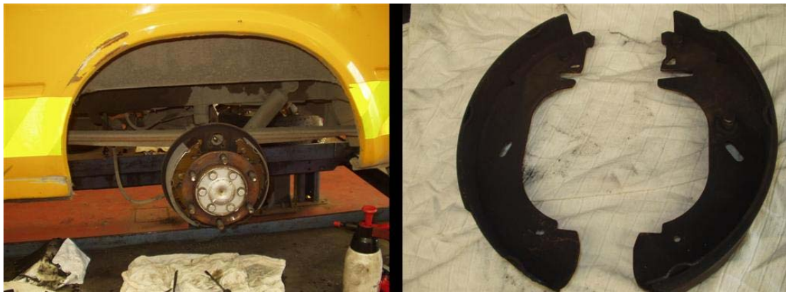
Fotografía 18.1 Amianto en las zapatas de freno de un camión.
