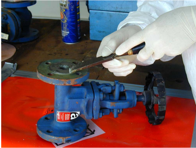
Fotografía 11.5 Empleo exclusivamente de herramientas manuales para limpiar las juntas y los residuos de amianto de la válvula.
